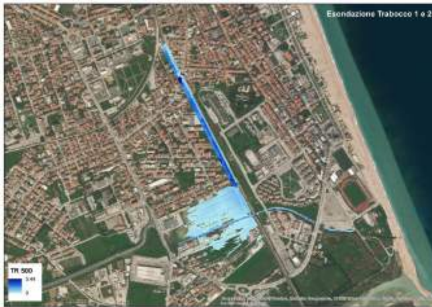
Scenario, esempio (sullo stato attuale), delle aree di esondazione dei due canali con Tempo di ritorno max di 500 anni
